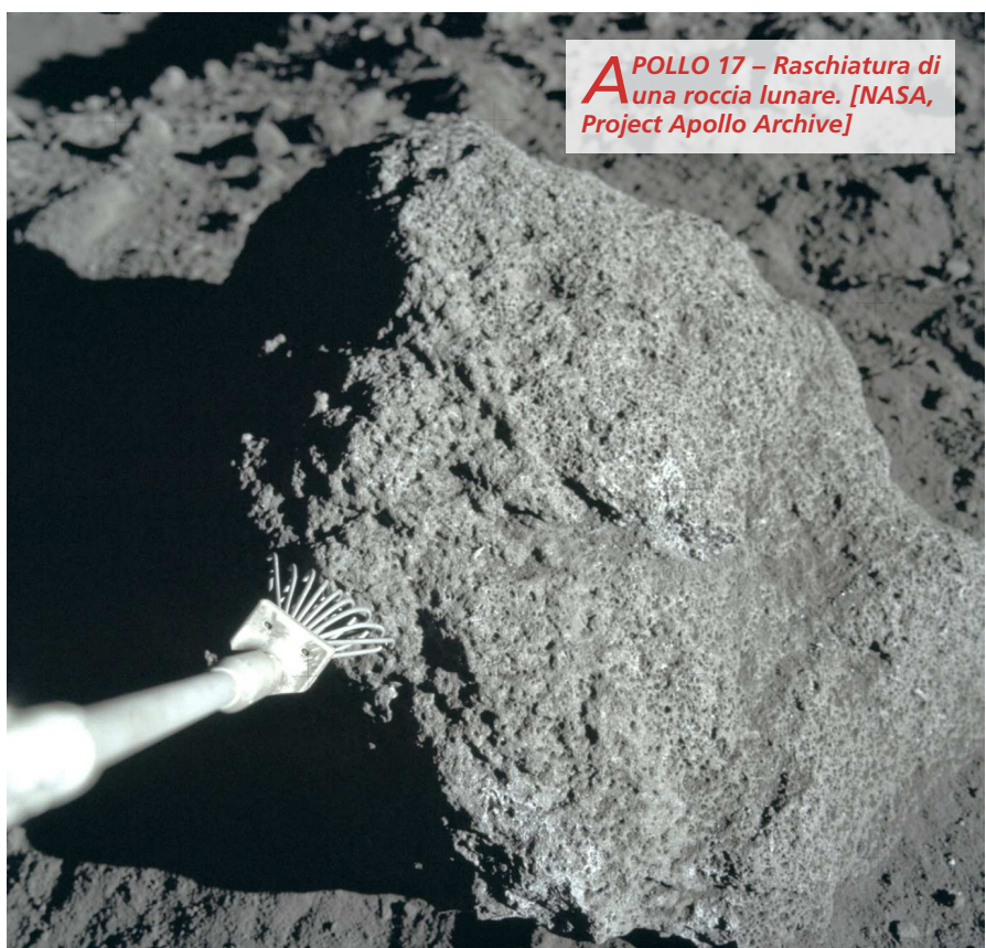
A POLLO 17 – Attrezzatura per la raccolta di campioni lunari. [NASA, Project Apollo Archive]
